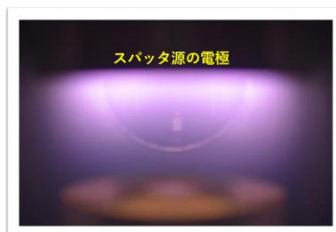
図1(b) スパッタ放電プラズマの発光の様子
