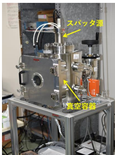
図1(a) ネオ放電モード型スパッタ装置
